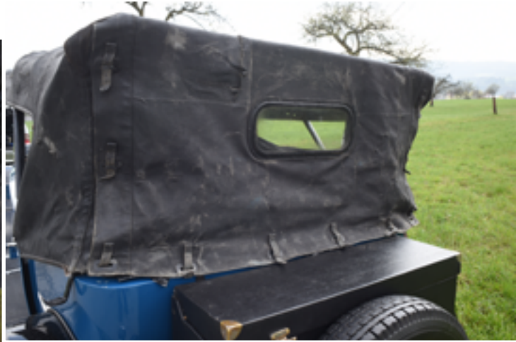
Přestože jsou boky ve značné délce otevřené, při jízdě dovnitř kupodivu neprší. Starou střechu zespodu provizorně utěsnili plastovou fólií.
