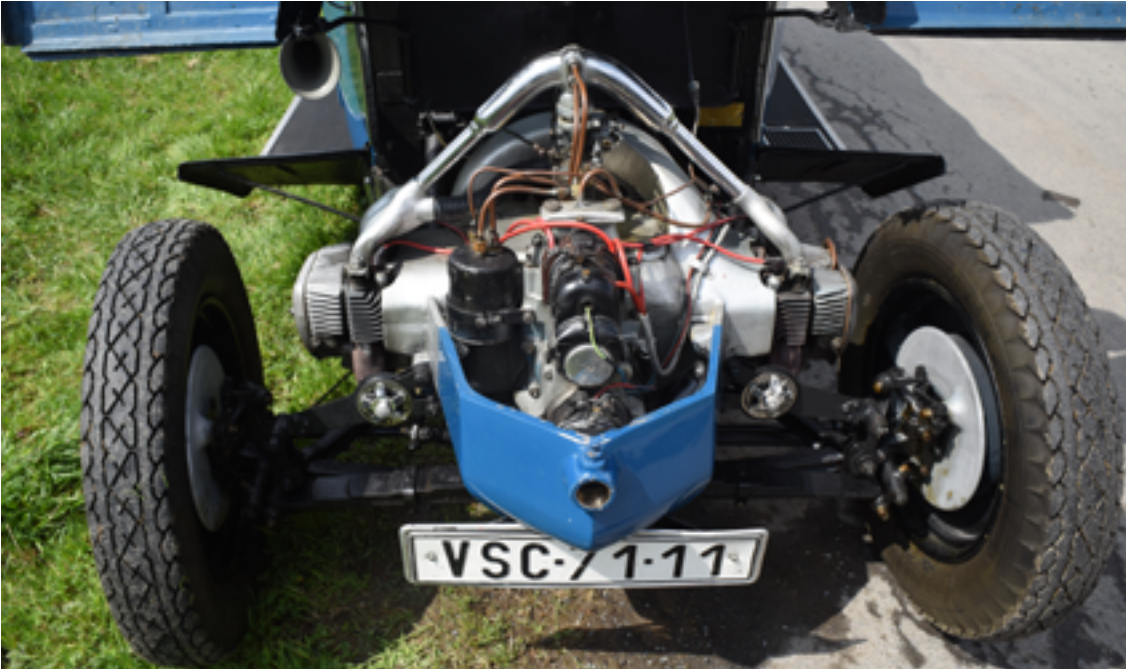
Pod žehličkovitou kapotou, vyklápenou spolu se světlomety a blatníky, pracuje vzduchem chlazený čtyřválcový boxer. Obejde se bez řemenu i palivového čerpadla, vše je snadno přístupné.
