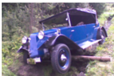
Při jedné ze soutěží neudržely sjeté a stářím ztvrdlé pneumatiky třicítka na silnici. Odnesla to přední náprava a blatník.
