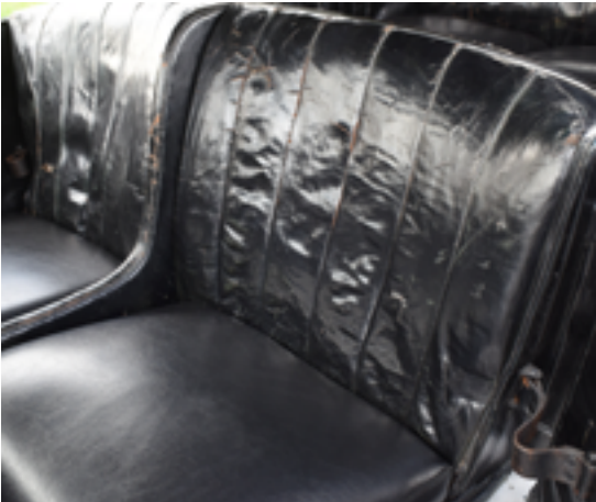
Většina čalounění je původní, vyměněna byla jen kůže na nepotřebovanějších místech - sedácích
