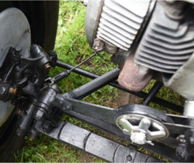
Tuhá náprava s příčným půleliptickým perem a trojúhelníkovou vzpěrou dostala třecí tlumiče a lankové brzdy
