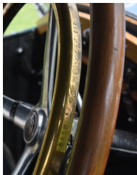
Za první republiky se u nás ještě jezdilo vlevo, proto volant na pravé straně. Vnitřní okružní ovládá klakson.
